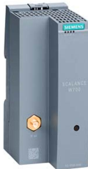
Client WLAN, SCALANCE W722-1, RJ45, 1 radio, 1 connexion d'antenne R-SMA prise en charge d'iFeatures IEEE 802.11a/b/g/h/n, 2,4/5GHz, débit de données brut 150 Mbit/s, 1x RJ45 max. 100 Mbit/s 24 V CC, bornier, IP20, 0 ... +55°C, WPA2/802.11i/e, Respecter les homologations nationales ! ID CERT: ELN-W1-RJ-E1, Contenu de la livraison : manuels sur CD-ROM, allemand/anglais, 1x bornier; pour une mise en œuvre en-dehors des Etats-Unis/d'Israël
