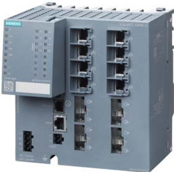
SCALANCE XM408-4C; commutateur modulaire IE managé; 8x 10/100/1 000 Mbit/s RJ45; 4x 100/1000 Mbit/s ST/SC enfichables comme combo-ports; soit un total de 8 ports utilisables; extensible à 24 ports électriques ou optiques; montage: rail DIN/profilé support S7; Périphérique PROFINET IO; fonctions de redondance; Office (fonctionnalités) (RSTP, VLAN, IGMP,...) ; C-PLUG fourni à la livraison; couche 3 avec Key-Plug disponible
