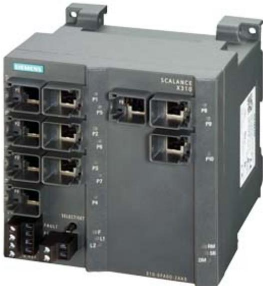
SCALANCE X310, managé plus IE, 3 x 10/100/1 000 Mbit/ et 7x ports RJ45 10/100 Mbits/s diagnostic LED, contact de signalisation de défaut contact avec bouton Select/Set, périphérique PROFINET IO, gestion de réseau, gestionnaire de redondance intégré, Office (fonctionnalités) (RSTP, VLAN, IGMP,...) C-PLUG fourni à la livraison
