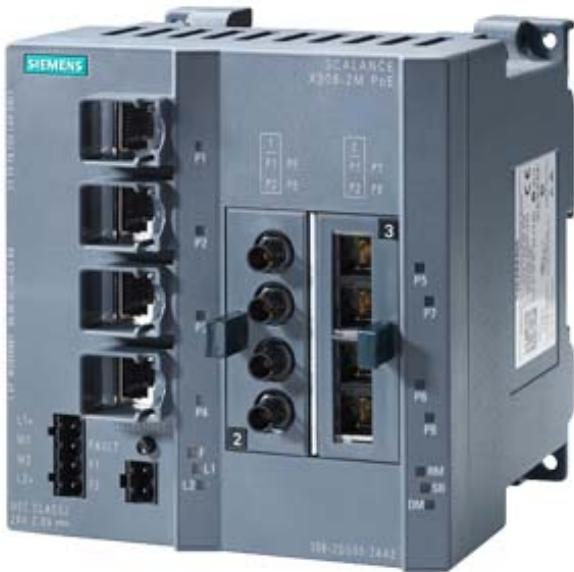
SCALANCE X308-2M PoE; commutateur IE, compact; 4x 10/100/1000 Mbit/s pour ports RJ45 électriques avec PoE; 100/1 000 Mbit/s pour cartouches de connexion 2 ports, électriques ou optiques; diagnostic LED, contact de signalisation de défaut contact avec bouton Select/Set, périphérique PROFINET IO, gestion de réseau, gestionnaire de redondance intégré, Office (fonctionnalités) (RSTP, VLAN, IGMP,..) C-PLUG fourni à la livraison
