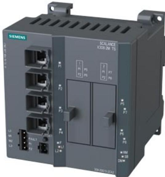
SCALANCE X308-2M TS; commutateur IE, compact; 4x 10/100/1000 Mbit/s pour ports RJ45 électriques; 100/1 000 Mbit/s pour cartouches de connexion 2 ports, électriques ou optiques; biagnostic LED; contact de signalisation de défaut contact; Périphérique PROFINET IO; gestion de réseau; gestionnaire de redondance intégré; fonctionnalités Office (RSTP, VLAN, IGMP,..) ; C-PLUG fourni
