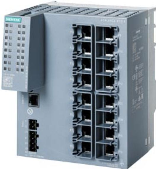
SCALANCE XC216 Commutateur IE couche 2 gérable ; homologué CEI 62443-4-2 ; 16X 10/100 Mbit/s ports RJ45 ; 1x port consoles, LED de diagnostic ; alimentation redondante ; plage de température -40°C à +70°C ; montage: sur rail DIN symétrique/profilé support S7/mural Fonctions de redondance Office Features (RSTP, VLAN,...); périphérique PROFINET IO ; conforme Ethernet/IP, Logement C-PLUG ;
