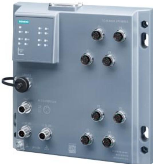
SCALANCE XP208EEC, managed IE géré avec homologation ferroviaire homologué CEI 62443-4-2 ; (EN 50155, EN 45545) 8x ports M12 10/100 Mbit/s, IP65 LED de diagnostic, contact de signalisation de défaut, alimentation redondante, périphérique PROFINET IO, gestion de réseau, utilisable en anneau redondant, capuchon antipoussière, incl. manuel électronique sur CD-ROM, C-PLUG en option
