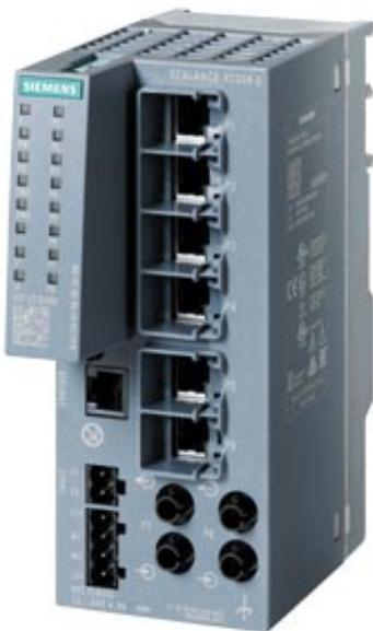
SCALANCE XC206-2 Commutateur IE couche 2 gérable ; homologué CEI 62443-4-2 ; 6x ports RJ45 100 Mbit/s ; 2x ports ST/BFOC 100 Mbit/s ; 1x port consoles ; LED de diagnostic ; alimentation redondante ; plage de température -40°C à +70°C ; montage: sur rail DIN symétrique/profilé support S7/mural fonctions de redondance; Office Features (RSTP, VLAN,...); périphérique PROFINET IO ; Ethernet/conforme IP logement C-PLUG ;
