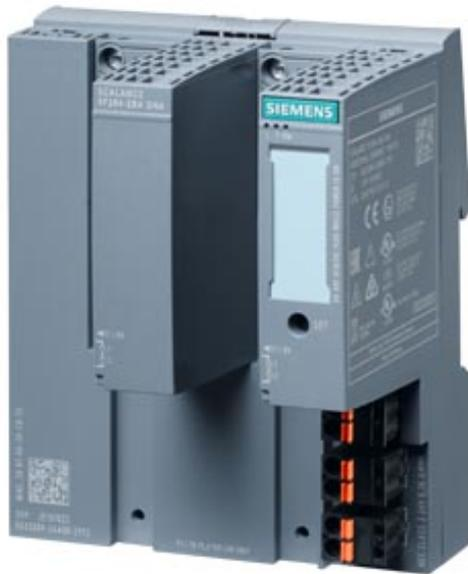
SCALANCE XF204-2BA DNA commutateur Y IE managé, homologué CEI 62443-4-2 ; 4 x 10/100 Mbit/s, 2 x interfaces adaptateur de bus, contact de signalisation de défaut, bouton Set, alimentation 24 V CC redondante, périphérique PROFINET, plage de température étendue -40 °C ... + 70 °C, Conformal Coating, avec manuel électronique sur DVD, C-PLUG en option, livré sans adaptateur de bus
