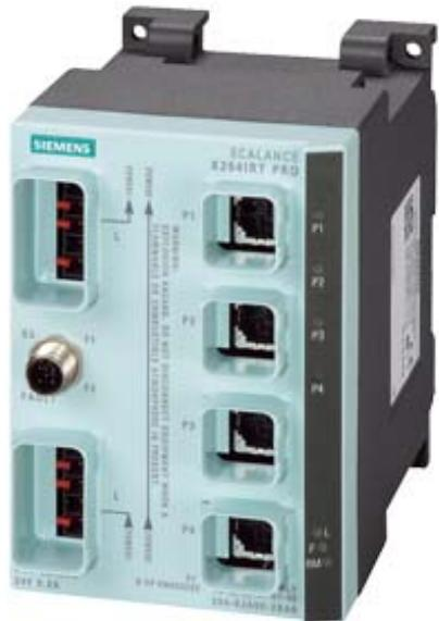
SCALANCE X204IRT PRO, commutateur IE IRT managé en indice de protection IP65/67, 4x 10/100 Mbit/s ports RJ45 Push Pull, contact de signalisation de défaut avec bouton Set; alimentation alimentation en tension; PROFINET périphérique IO, gestion de réseau, gestionnaire de redondance intégré, incluant manuel électronique sur CD-ROM, C-PLUG en option
