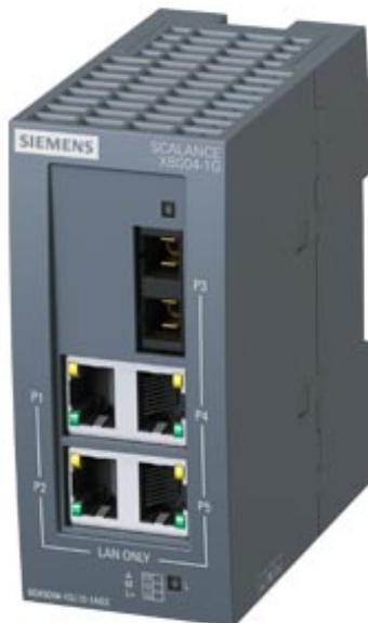
SCALANCE XB004-1G non managé Industrial Ethernet non managé pour 10/100/1 000 Mbit/s; pour le montage de petites structures en étoile et et structures linéaires; diagnostic LED, IP20, 24V CC en tension redondante, avec 4x 10/100/1 000 Mbit/s, ports RJ45 électriques et 1 x 1 000 Mbit/s port SC optique (multimode, verre), jusqu'à max. 750m manuel disponible en téléchargement
