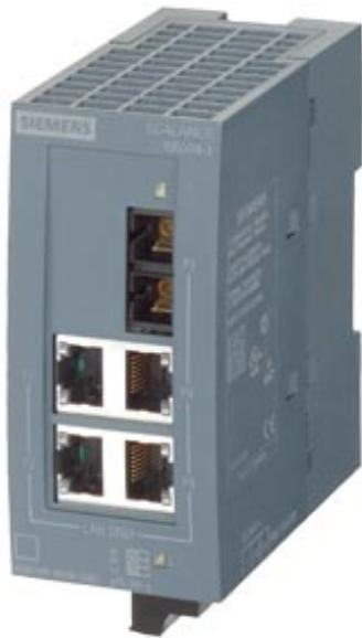
SCALANCE XB004-1LD commutateur Industrial Ethernet non managé pour (10/100 Mbit/s); pour le montage de petites structures en étoile et structures linéaires; diagnostic LED, IP20, 24V CA/CC en tension redondante, avec 4x paires torsadées 10/100 Mbit/s ports avec connecteurs femelles RJ45; 1 x 100 Mbit/s monomode verre port LWL avec prise femelle SC; manuel disponible en téléchargement
