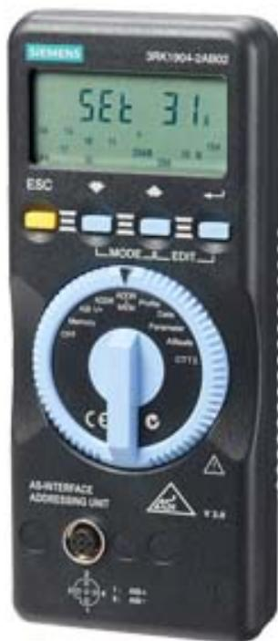
console d'adressage AS-Interface V3.0 pour réglage des adresses de modules esclave AS-i test d'entrée/de sortie et autres fonctions spécification AS-i V3.0 connecteur femelle M12 avec ligne d'adressage 1,5 m (connecteur mâle M12 / connecteur creux) avec piles (4 x 1,5 V LR6)
